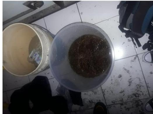
**Gambar 4.1.** Serat sabut kelapa dalam proses perendaman NaOH 5%
